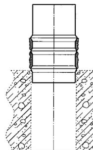
Jetzt wird die Hülse mittels Hammer und Einschlagwerkzeug bzw. Einpressvorrichtung in das Bohrloch eingetrieben. Die Montagetiefe ist erreicht, wenn die obere – etwas breitere – Sicke Kontakt mit der Decke hat.
