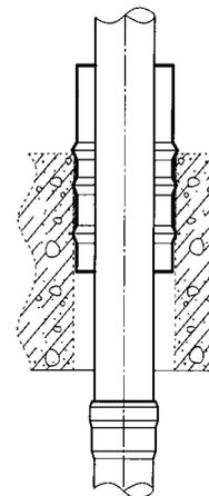
Das nebenstehende Montagewerkzeug bzw. die nicht abgebildete Einpressvorrichtung erleichtern und beschleunigen das Eintreiben der Hülse.
