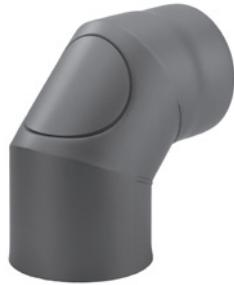
**Bögen, zylindrisch, eingezogen, 90°, mit versenkter Tür und Dichtung, Schweißnaht verschliffen**
